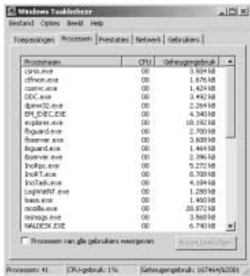
Afbeelding 4. Het Windows-taakoverzicht laat zien dat de Firebird-server in rustige tijden slechts 3,6 MB aan geheugen opeet.
