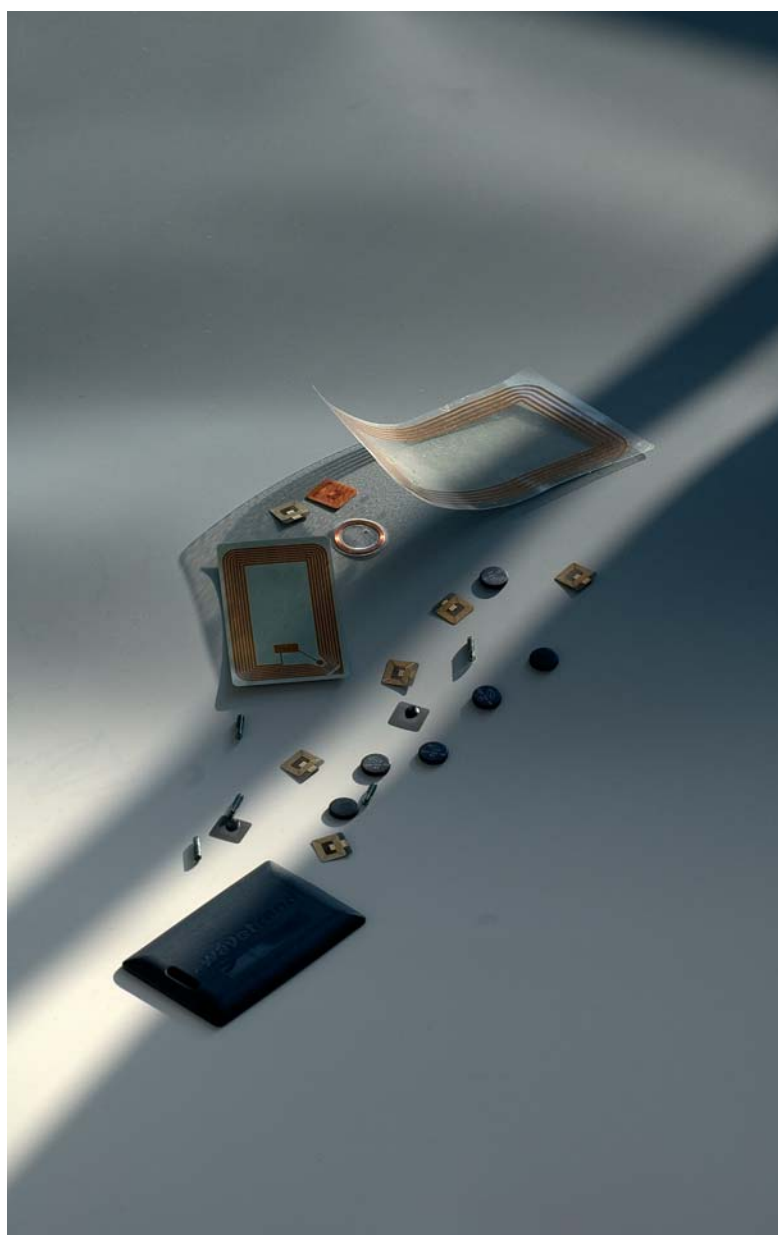
RFID-tags zijn onder te verdelen in passieve en actieve tags. (illustratie Dré de Man)
