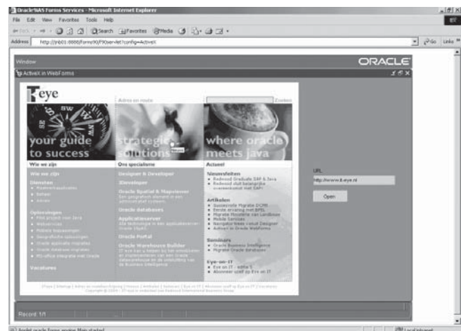
Afbeelding 1. Microsoft Internet Explorer is hier ingebed in een Forms-module.
