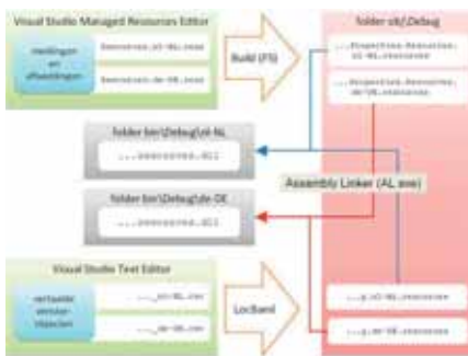
AFBEELDING 2. HET PROCES VAN RESOURCES.DLL BESTANDEN MAKEN IN SCHEMAVORM
