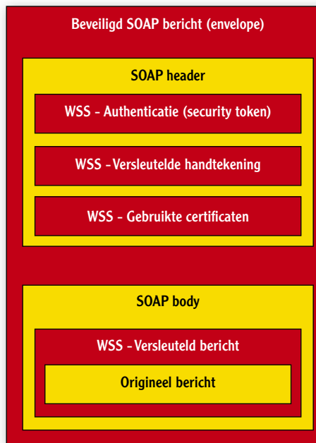
Afbeelding 2. Structuur van een met WS-Security beveiligd SOAP-bericht
