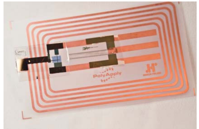
Afbeelding 2: Een moderne RFID tag in de vorm van opplakbare folie.
