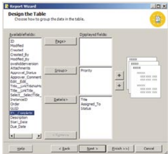
Afbeelding 3. Automatisch worden alle velden (inclusief calculated fields) van de geselecteerde lijst aangeboden.
