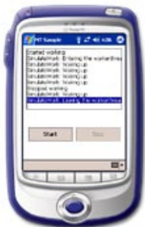
Afbeelding 3. Simultane updates van de listbox vanuit de werkerthread en vanuit de main thread
