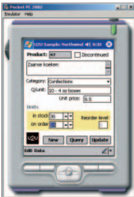
Afbeelding 1. Een toepassingsmogelijkheid in het .NET Compact Framework: Zaanse koeken bestellen via ADO.NET en XML Web services op een Pocket PC
